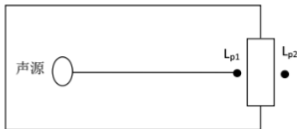
图 6.4-1 室内声源等效为室外声源示意图
